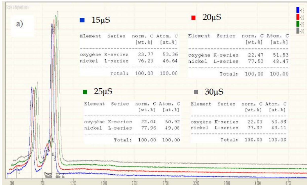
Hình 7: Kết quả phân tích EDS của các mẫu Ni x O 15 \mu\text{s} , 20 \mu\text{s} , 25 \mu\text{s} , 30 \mu\text{s} .
