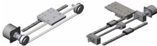
Hình 4. Tạo chuyển động thẳng gián tiếp sử dụng đai truyền, trục vít
